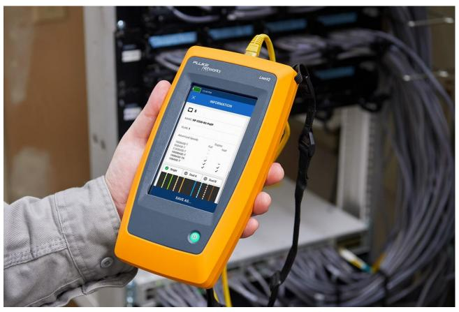
フルーク・ネットワークスの LinkIQ™ は、効率的かつ正確にケーブルをトレース、 追跡、トラブルシューティング、および認定するために必要な機能を提供します。
