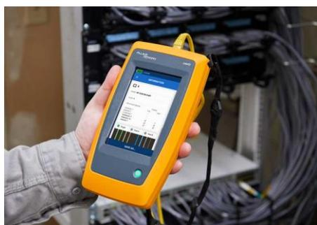
写真 5-6 LinkIQ™ ケーブル+ネットワーク・テスター
