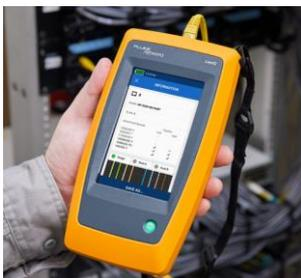
写真 6-7 LinkIQ™ ケーブル+ネットワーク・テスター
