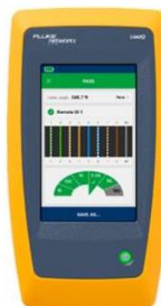
写真 5-5 LinkIQ™ ケーブル+ネットワーク・テスター
