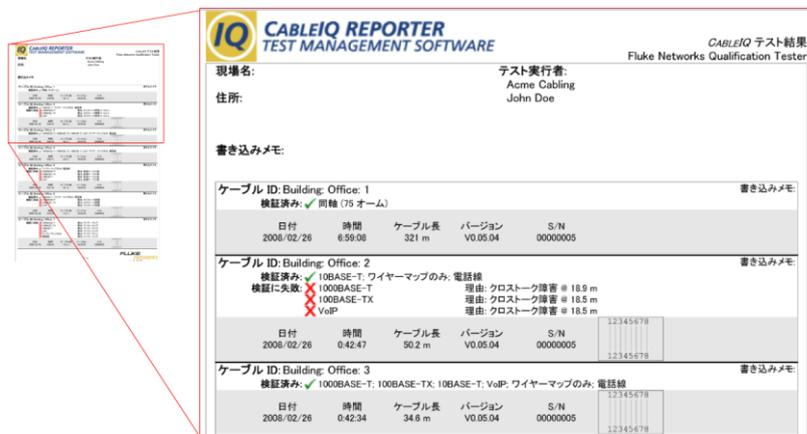
図 6-9 試験結果レポート画面例
