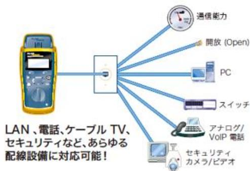
図 6-1 音声、VoIP、10/100/1000 イーサネット、そして CATV をサポート可能なことを迅速に検証
