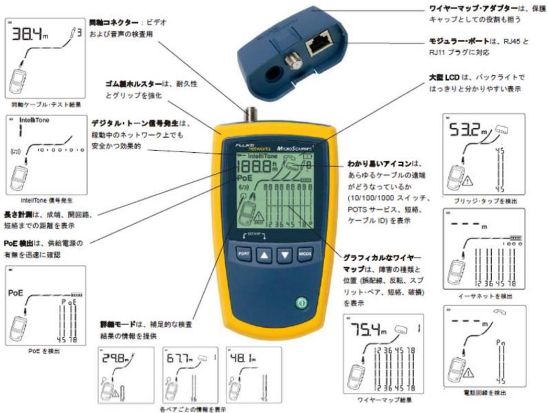
図 6-15 MicroScanner<sup>2</sup> 配線検査テスターの多様な試験機能
