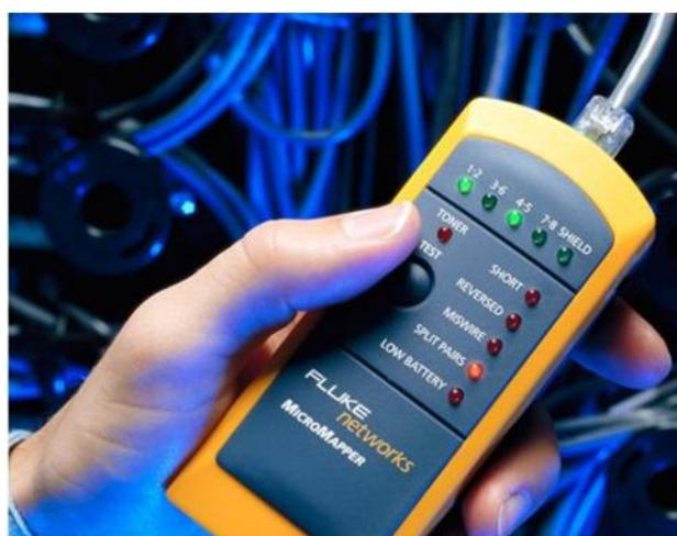
写真 6-8 MicroMapper (マイクロマッパー) 配線検査テスター
