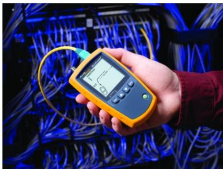
写真 6-5 MicroScanner<sup>2</sup> 配線検査テスター
